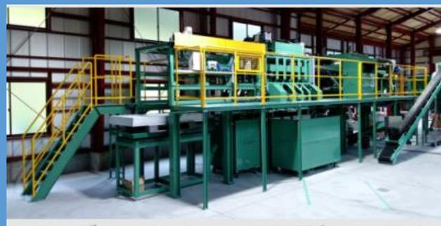
どの設備を利用しても、処理後はジャンクションボックス、アルミ、ガラス、バックシートの4つに分離されます。
